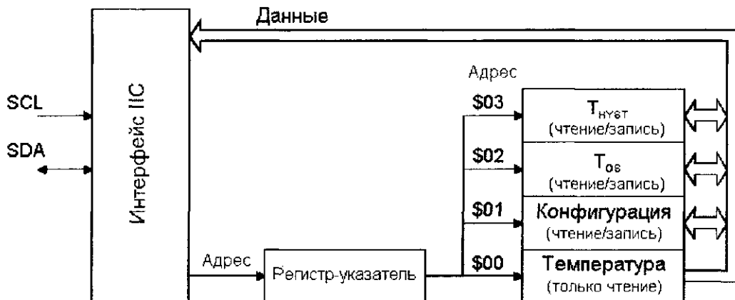
Рис. 16.49. Внутренняя регистровая структура датчика LM75
