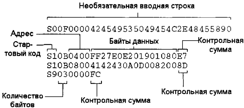
Рис. 13.2. Структура строк в формате Motorola S-record
