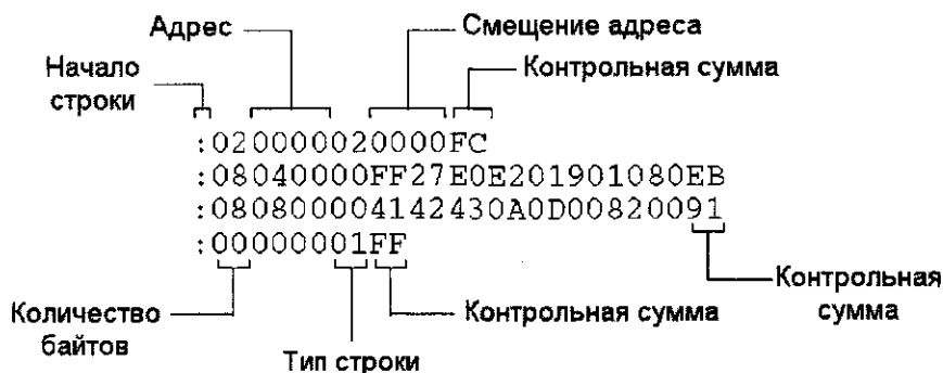
Рис. 13.1. Структура строк в формате Intel Intellec 8/MDS
