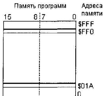
Рис. 3.27. Относительная адресация памяти программ
