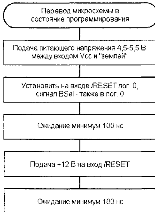
Рис. 11.3. Последовательность действий для перевода микросхемы в режим программирования
