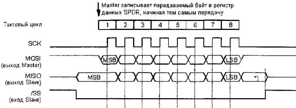
Рис. 7.4. Формат передачи через интерфейс SPI, если CPHA = \text{лог. 0} , CPOL = \text{лог. 0}
