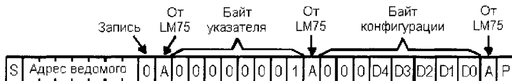
Рис. 16.54. Типичная инициализация байта конфигурации
