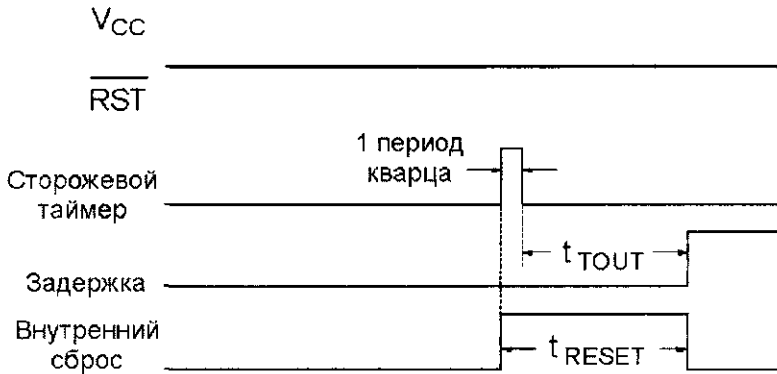
Рис. 3.36. Сброс по сторожевому таймеру во время выполнения программы
