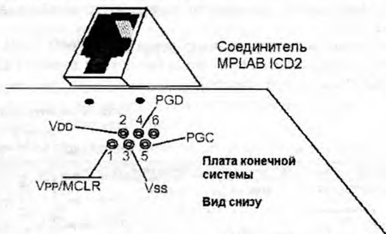
Рис. 9.3. Шестиконтактный RJ-разъем для соединения с конечным устройством
