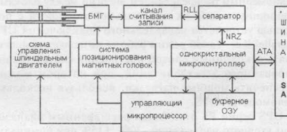
Рис. 1. Структурная схема винчестера АТА
