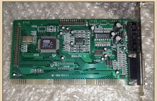
Относительно редкая модификация ESS1868 со схемой Binaura 3D
