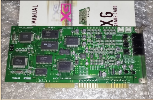
Волновой MIDI XG-синтезатор Yamaha SW60XG на отдельной ISA-плате
