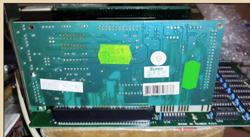
ESS1868 установлена в 8-битный слот материнской платы 8088 XT
