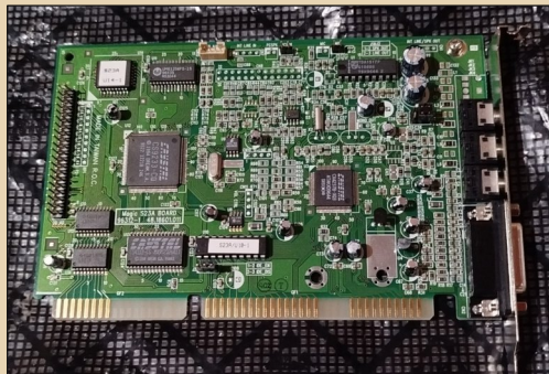
Acer Magic S32A – простая на вид плата, оснащённая волновым MIDI-синтезатором Crystal CS9233
