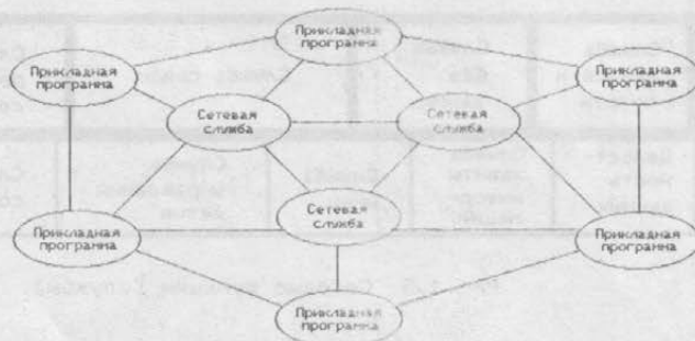
Рис. 1.3. Прикладные программы могут быть распределены между сетевыми функциями
