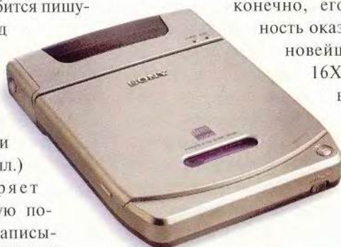
Digital Relay CRX10U-A2 фирмы Sony воспроизводит компакт-диски и записывает CD-RW
