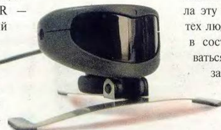
Устройство TrackIR дает возможность управлять экранным указателем легким движением головы
