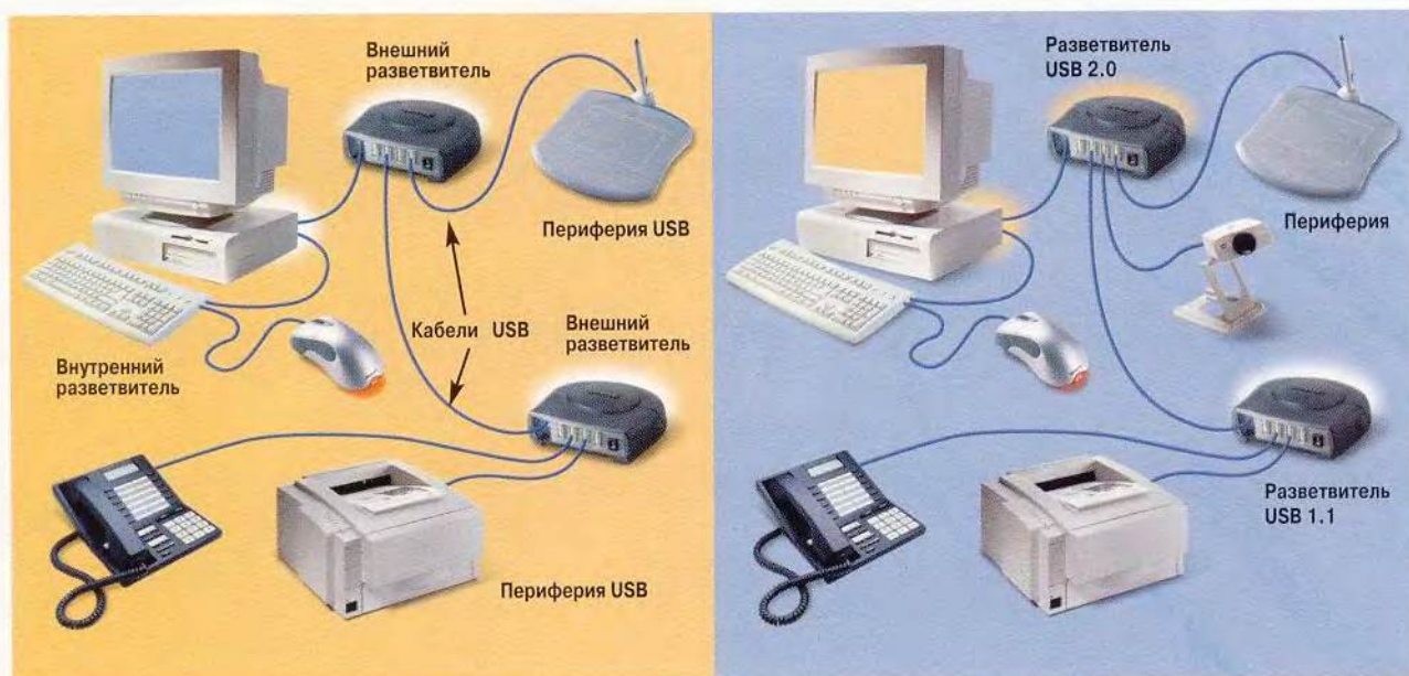
Рис. 1. Схемы подсоединения оборудования к ПК
