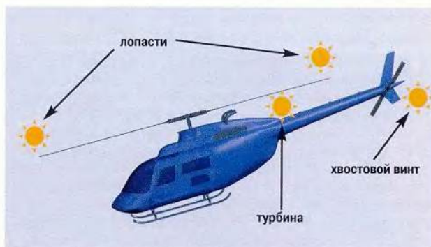
Расположение звуковых источников на реальном вертолете
