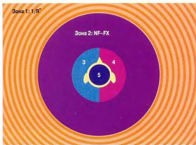
Звуковые зоны, определяемые технологией MacroFX: зона 1 — дальнее поле, где интенсивность звука обратно пропорциональна расстоянию; NF-FX (зона 2) — зона эффектов ближнего поля; зона 3 — область левого уха; зона 4 — область правого уха; зона 5 — область внутри головы (внешняя зона не показана)
