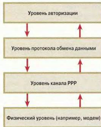
Рис. 1. Общая структура PPP-соединения
