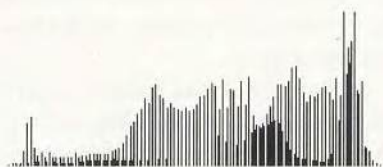
Гистограмма «расческа» характерна для изображений, подвергшихся чрезмерному увеличению тонового диапазона
