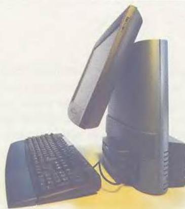
Система Acer Verition FP2 имеет отсоединяемый монитор
