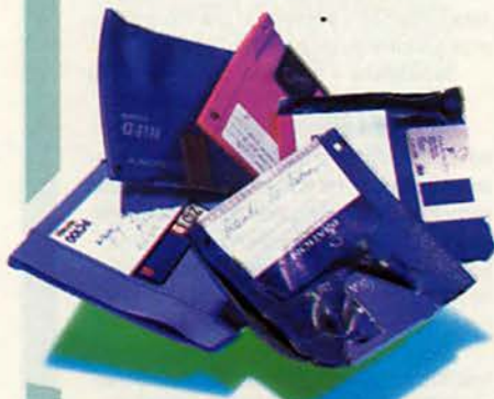
Флоппиподобные диски, деформированные из-за интенсивного нагрева
