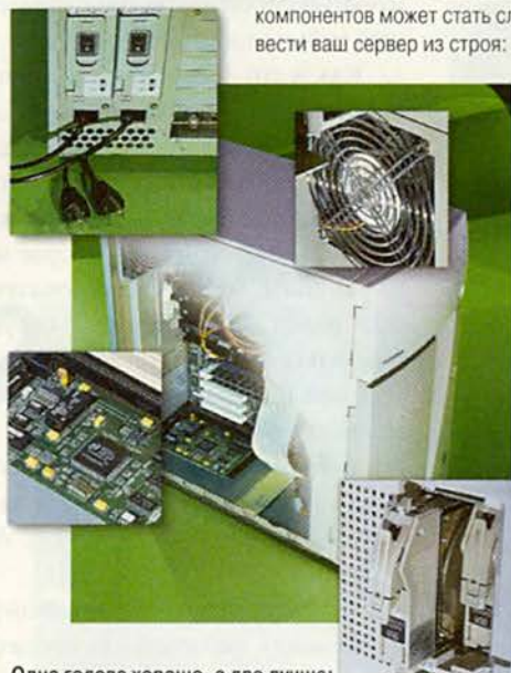
Одна голова хорошо, а две лучше: в сервере Toshiba Magnia 3000 в целях повышения надежности применены резервные вентиляторы и источники питания
