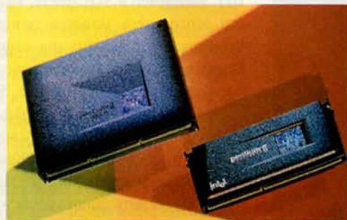
Рядом с Pentium II Хеон (слева) картридж Pentium II кажется карликовым
