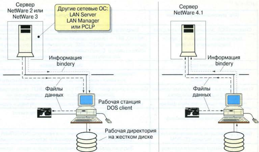
Рис. 2. Функциональная схема миграции на тот же сервер
