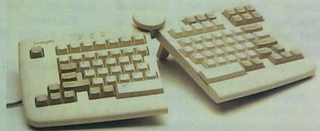
Клавиатура, «расколотая» пополам: новая эргономичная модель Select-Ease фирмы Lexmark. Расположенный посередине крепежный винт позволяет фиксировать ее половины в любом удобном для пользователя положении.
