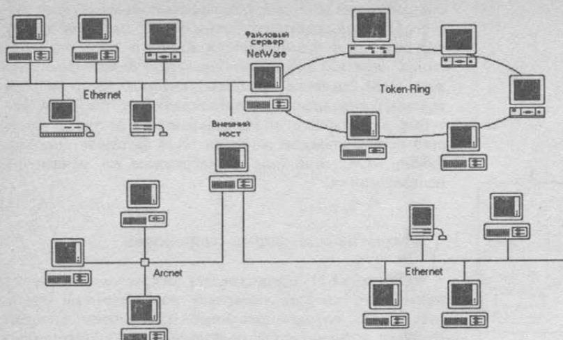
Рис. 3.6. Внешний мост NetWare v3.11
