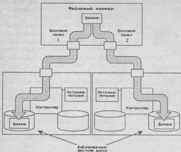
Рис. 3.4. Дублирование диска NetWare v3.11
