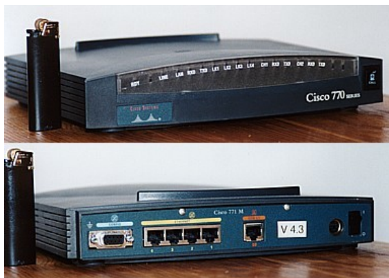
Сетевой шлюз со встроенным коммутатором. Вид спереди (вверху) и сзади (внизу)
