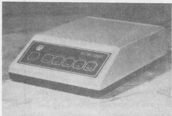
Асинхронный полудуплексный внешний модем ИСМ-1200 предназначен для передачи текстовой и графической информации между компьютерами, находящимися на любых расстояниях друг от друга по обычной телефонной сети (внутренней, городской, междугородной).
