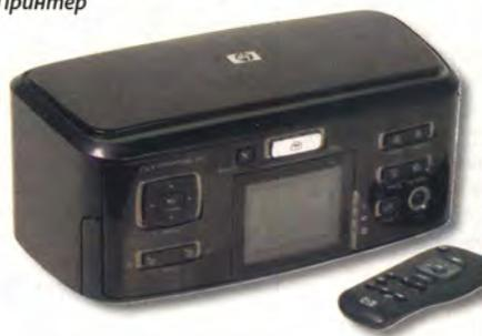
Трехцветная (CMY) термальная струйная печать HP Photoret III с разрешением до 4800x1200 dpi (при печати с компьютера — 1200 dpi). Для печати черно-белых отпечатков используется дополнительный серый картридж (три градации серого).
