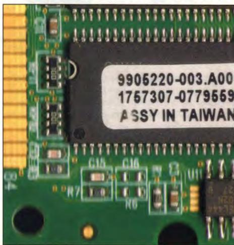
Рис. 3. Фрагмент печатной платы, полученный сканированием (50-кратное увеличение). Видно, что отстоящие от поверхности стекла детали не в фокусе. При использовании CCD-сканера такого эффекта обычно не бывает
