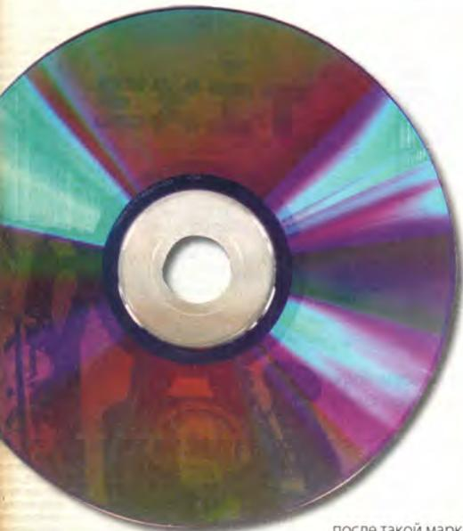
после такой маркировки незадействованная часть рабочей поверхности уже не будет доступна для записи. Сама же картинка получается довольно блеклой
