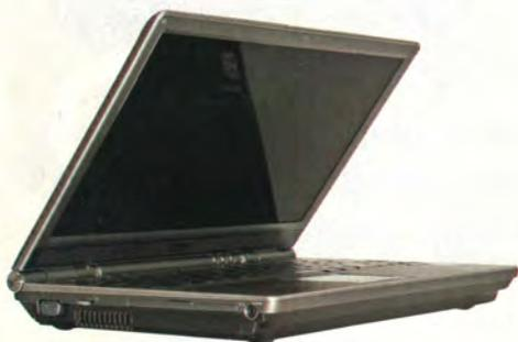
ЛЕВАЯ ПАНЕЛЬ VGA, вкл. Wi-Fi, 2 USB, RJ45, RJ11, line-in/mic, наушники/SPDIF
