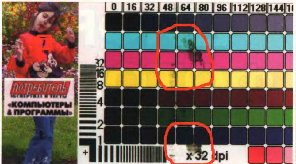
Рис. 3. Одно из последствий попадания чернил в механизм принтера
